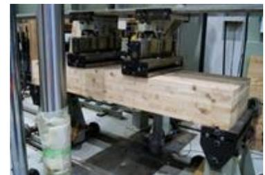
CLTの耐荷重試験
